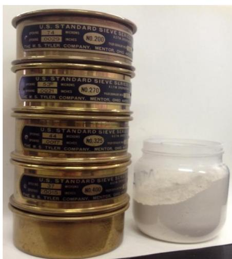
**Figura 1.** Tamices superpuestos utilizados para la separación de partículas de dolomita.
