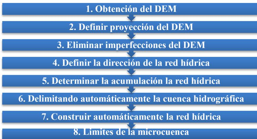
**Figura 2:** Procedimiento de la delimitación para una cuenca hidrográfica.
